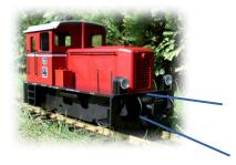
Die Fronthabe kann durch vorsichtiges Drücken an der rechten und linken unteren vorderen Seite neben dem Lüftungsgitter geöffnet werden. Es sind Rastnasen vorhanden. Es empfiehlt sich, die Schrauben des Führerhauses etwas zu lösen, dann gibt es Spiel für die Fronthaube und die Rastnasen werden entlastet.
